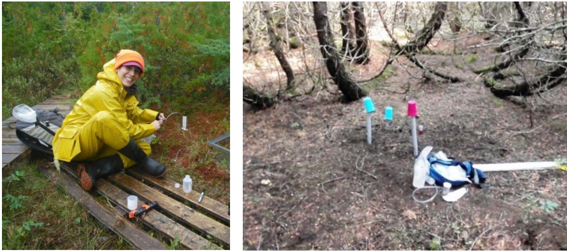
Figure 19 : Suivi de l'hydrologie. À gauche : échantillonnage de l'eau dans la tourbière naturelle située à l'est du secteur restauré de Bic-Saint-Fabien. À droite : puits hydrologiques dans la cédrière située au nord.
