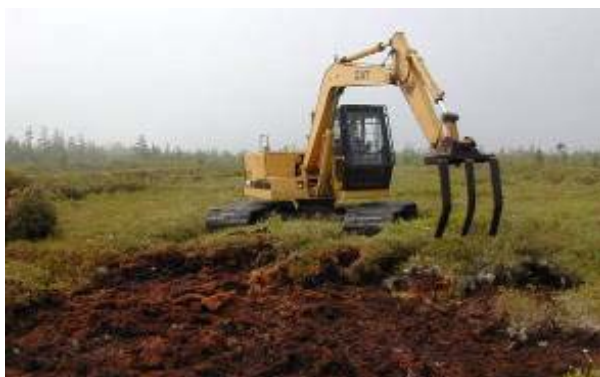
5a. Retrait de la végétation à l'aide d'une excavatrice équipée d'une fourche mécanisée.
