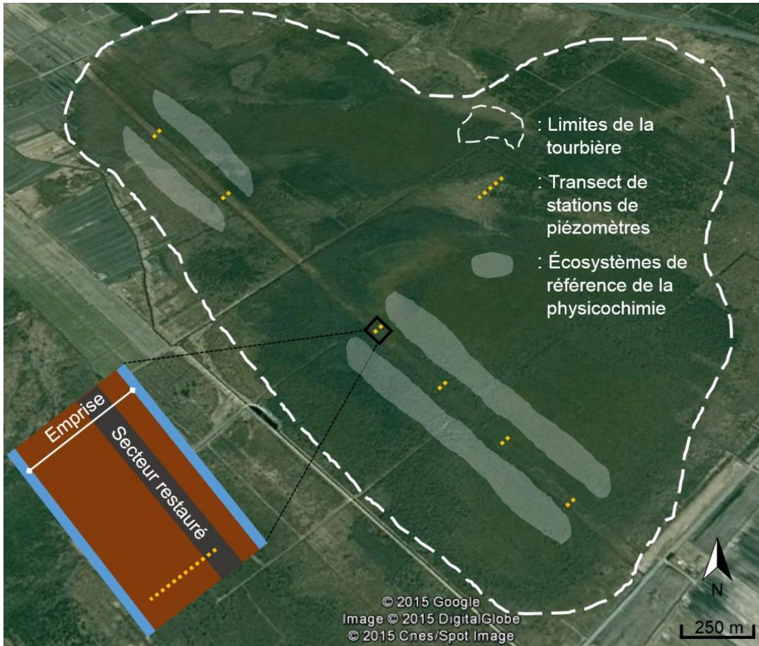
Figure 6 - Transects de stations de piézomètres pour l'échantillonnage de l'eau à Sainte-Eulalie.
