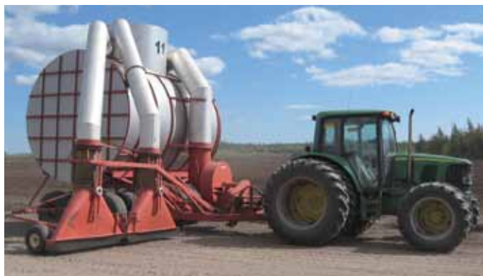
Figure 4. Aspirateurs utilisés pour la récolte de la tourbe.
