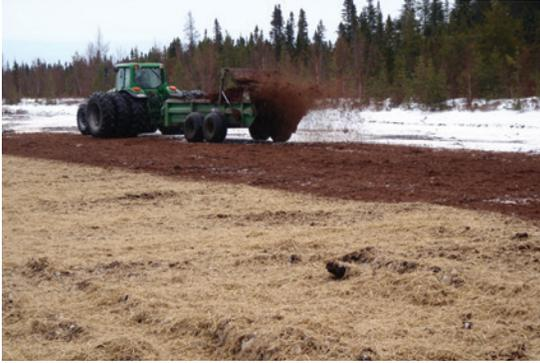
**Figure 3.** Épandage du matériel végétal à l'aide d'un épandeur à fumier à panneau hydraulique et batteurs horizontaux.
