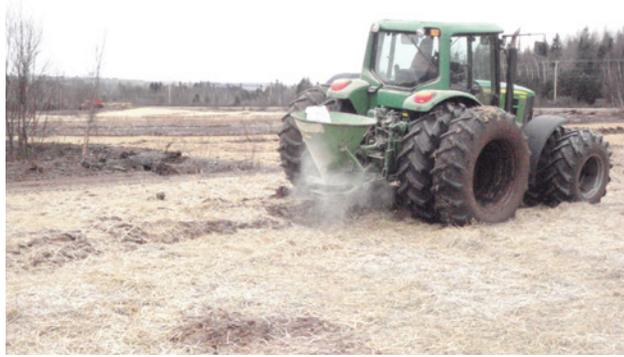
**Figure 11.** Application de fertilisant à l'aide d'un épandeur conique fixé à la prise de force du tracteur.
