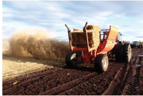
Figure 9. Pailleuse latérale (vue arrière).
