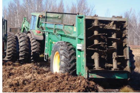
**Figure 4.** Épandeur à fumier à tablier avec batteurs verticaux.
