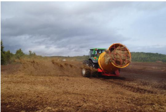
Figure 10. Pailleuse latérale à chargement arrière.
