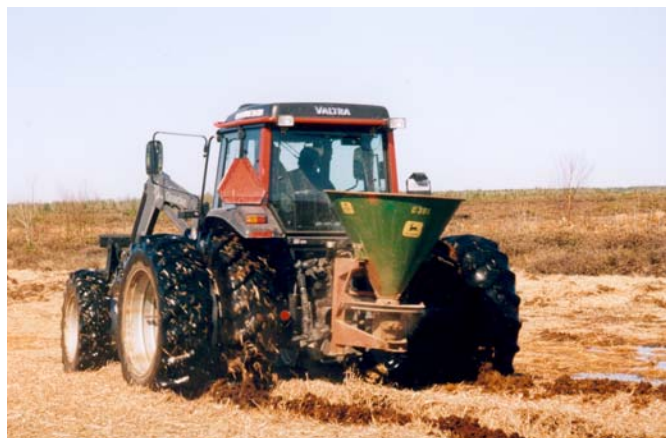
Figure 20. Application de fertilisant à l'aide d'un épandeur conique standard fixé à la prise de force du tracteur. (Photo : F. Quinty)
