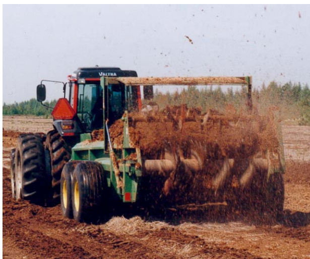
Figure 16. Épandage du matériel végétal à l'aide d'un épandeur à fumier conventionnel. (Photo F. Quinty)
