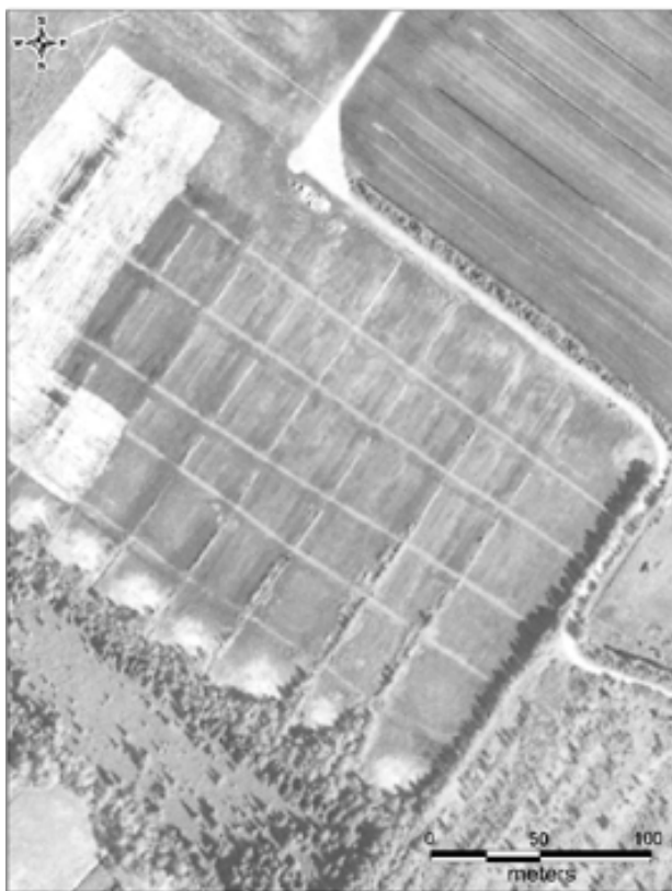
Figure 10. Photo aérienne du site en restauration de Chemin-du-Lac, au Québec. Pour réaliser une répartition uniforme de l'eau sur les pentes complexes et les planches courtes, des digues en damier ont été créées, formant des cellules d'environ 30 m de largeur. (Photo : Premier Horticulture ltée)
