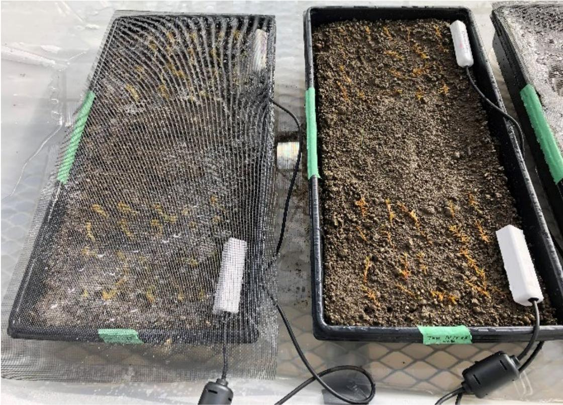
Figure 17 : Disposition de capteurs de teneur en eau du sol pour un plateau avec ombrage (côté gauche) et un plateau sans ombrage (côté droit) de l'expérience en serre sur la capacité de régénération de mousses et sphagnes typiques des fens (réalisée au NAIT Centre for Boreal Research)
