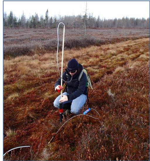
Fig. D. Mesure manuelle du niveau de la nappe phréatique dans une tourbière. / Manual measurement of the water table in a peatland. Photo : GRET/PERG
