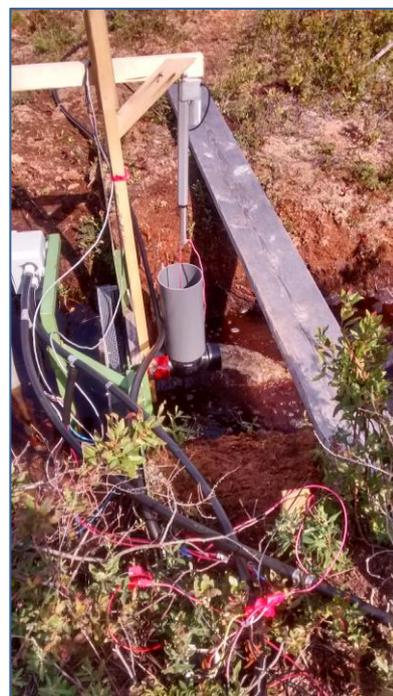
**Fig. C. Installation d'un barrage à hauteur variable. / Installation of a height-adjustable dam. Photo : G. Goulet.**
