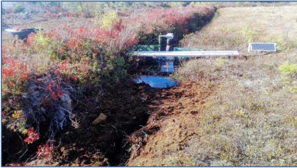
Fig. A. Appareillage pour mesurer le niveau d'eau dans un canal d'irrigation à la tourbière no. 530 de Shippagan (NB). / Apparatus for measuring the water level in an irrigation canal at the peatland no. 530 at Shippagan (NB). Photo: S. Gutierrez Pacheco.
