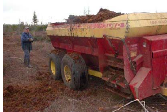
4d. Épandage du matériel végétal à l'aide d'un épandeur à fumier latéral.
