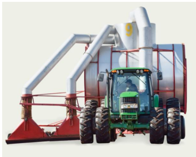
Figure 5: Tracteur équipé d'un aspirateur servant à extraire la tourbe (Berger, 2022).
