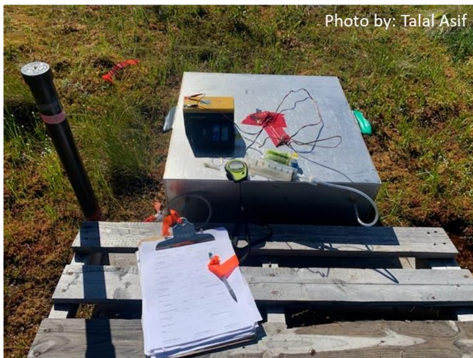
Figure 17: Chambre opaque pour mesurer des émissions de méthane avec un cylindre pour mesurer le niveau de la nappe phréatique.
