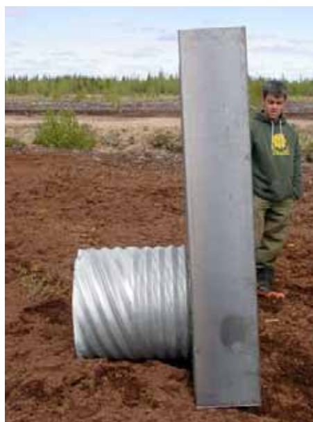
Figure 9. Barrage utilisé pour les essais sur la hauteur de la nappe d'eau à Pointe-Lebel (Québec).
