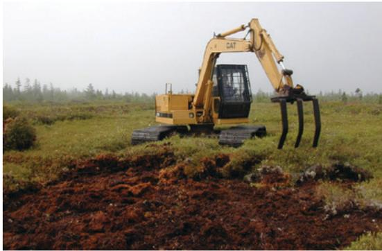
**Figure 20.** Récolte du matériel végétal dans un ancien site de coupe par bloc avec une excavatrice sur chenilles avec une fourche.
