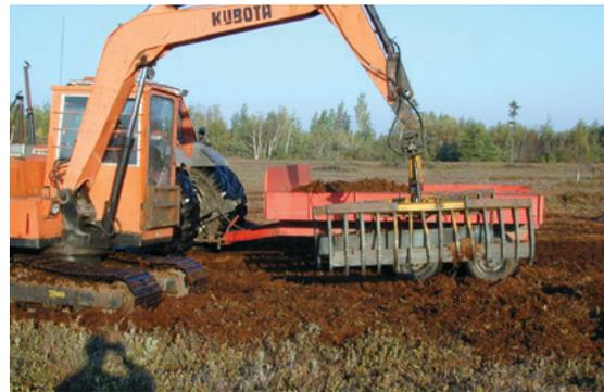
**Figure 23.** Ramassage du matériel végétal après le passage du rotoculteur.
