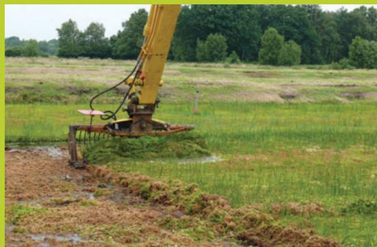
**Figure 37.** Utilisation d'une excavatrice avec une faucardeuse au bout de son bras pour couper la sphaigne.
