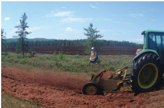
**Figure 22.** Déchiquetage du matériel végétal avec un rotoculteur dans une tourbière non-perturbée.
