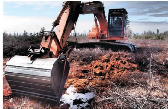
**Figure 21.** Récolte de matériel végétal dans un ancien site de coupe par bloc avec une excavatrice munie d'un godet grattant la couche de sphaignes dégelée en surface au printemps.
