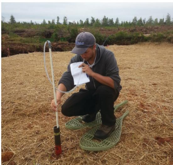
**Figure 29.** Utilisation d'un bulleur pour évaluer le niveau de l'eau dans un puits d'observation hydrologique. Le bulleur est composé de deux parties, un tuyau en PCV gradué et un tube flexible. En soufflant dans le bulleur, le niveau de l'eau est constaté et mesuré sur le tuyau gradué.
