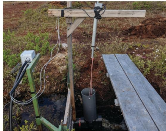
**Figure 19.** Barrage mobile fonctionnant avec un sonar mesurant le niveau d'eau dans le canal réservoir, et avec un actuateur linéaire et un flotteur (dans le tuyau gris) pour ouvrir la valve du barrage.
