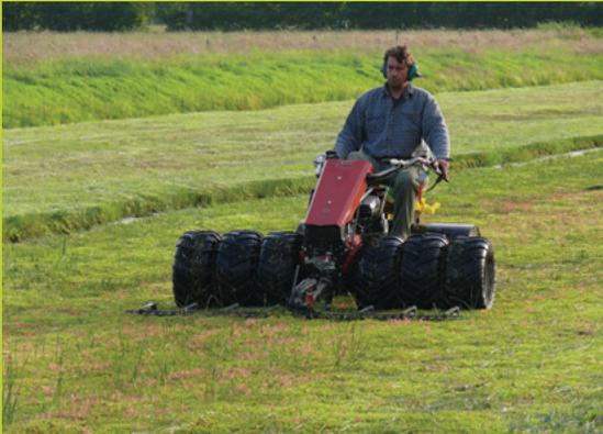
**Figure 32.** Utilisation d'une faucheuse à un seul essieu avec barre de coupe pour contrôler le jonc épars.
