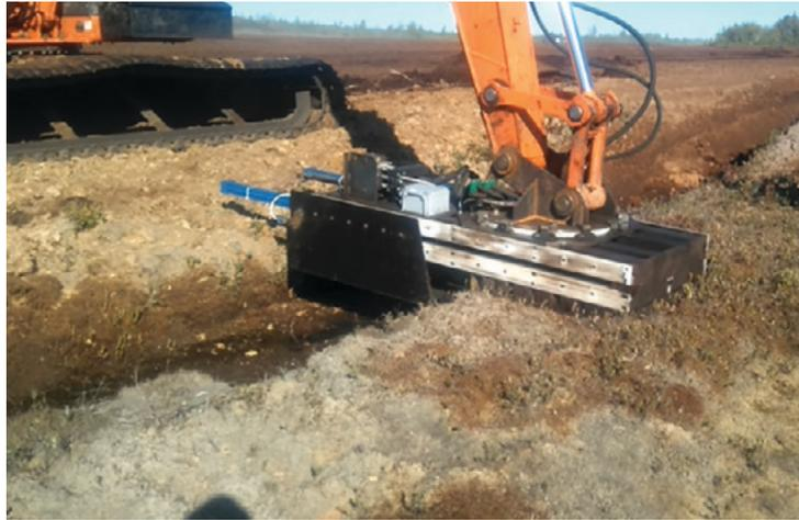
**Figure 40.** Appareil utilisé au Canada pour récolter la tourbe en coupe par bloc. Des tests ont démontré que cet équipement pourrait aussi servir à récolter la sphaigne.
