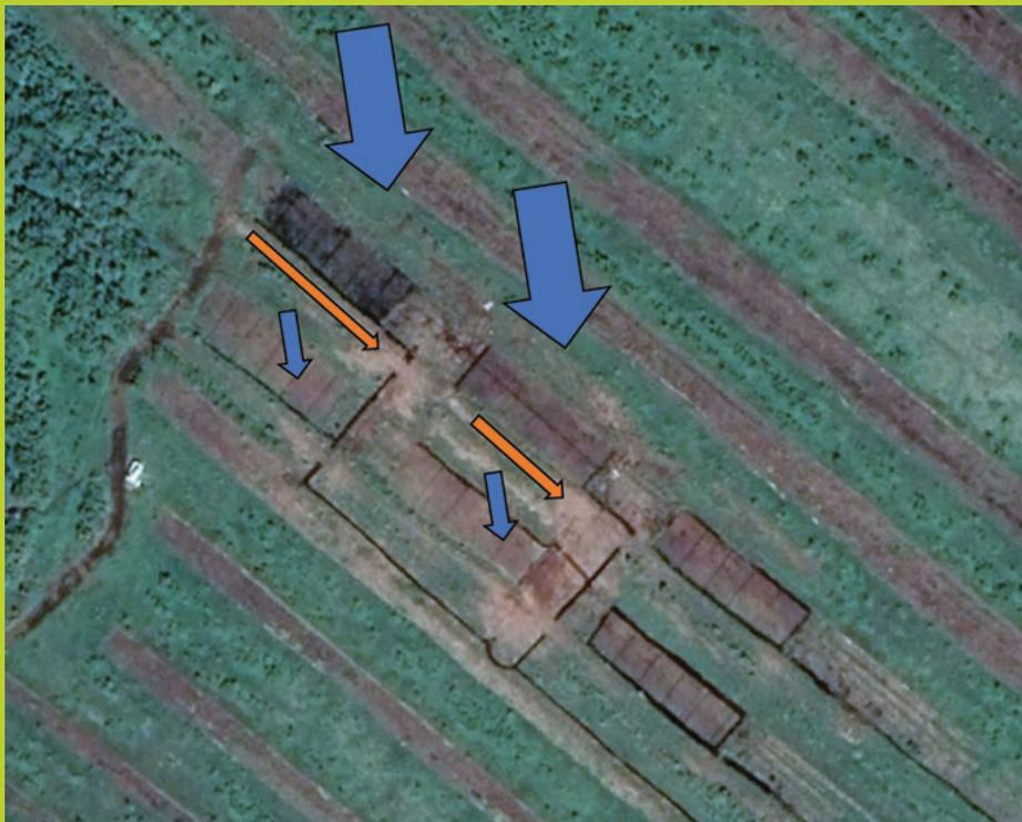
**Figure 14.** Interception de l'écoulement naturel de l'eau par les canaux réservoirs. Les flèches bleues indiquent l'intensité de l'écoulement naturel de l'eau et les flèches orange montrent l'écoulement intercepté par les canaux (image : 2022 CNES/Airbus).
