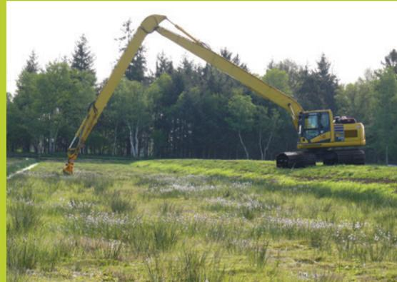
**Figure 33.** Utilisation d'une excavatrice à long bras équipée d'une faucardeuse, opérant depuis le terre-plein.
