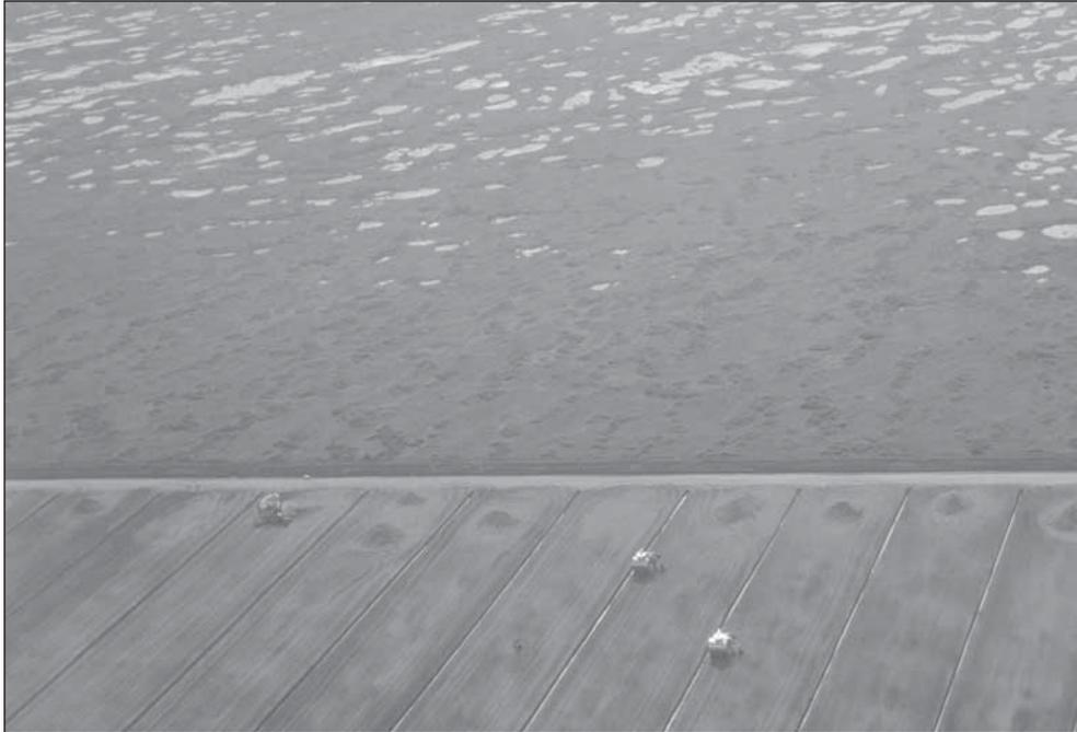
FIGURE 23.8. Aujourd'hui, la tourbe est récoltée par d'immenses aspirateurs. Pour faciliter le travail de la machinerie, le drainage est beaucoup plus intense et agit durant une période plus longue qu'anciennement. Les superficies en exploitation ont augmenté de même que l'impact sur l'environnement. À remarquer, la partie exploitée de la tourbière (bas de la photo) et la partie naturelle (haut de la photo) (photo : L. Rochefort).
