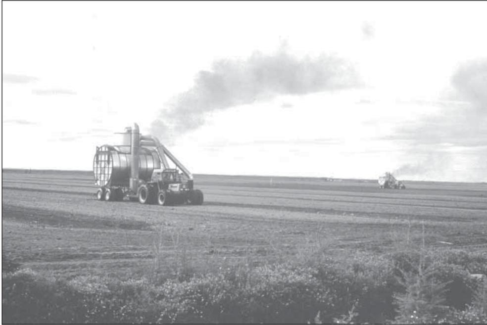
FIGURE 23.6. Machinerie spécialisée (aspirateur) servant à récolter la tourbe sur de grandes surfaces légèrement convexes et bien drainées (photo : M. Poulin).
