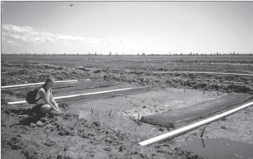
FIGURE 23.28. Expérience sur l'inondation superficielle ayant pour but de procurer un approvisionnement en eau adéquat aux fragments de sphaignes par une série de tuyaux perforés. Quatre espèces de sphaignes ont été introduites dans des bassins peu profonds de 10 m × 12 m × 20 cm et la moitié des parcelles principales ont été recouvertes d'une ombrière coupant 60 % de la lumière incidente (photo : L. Rocheffort).
